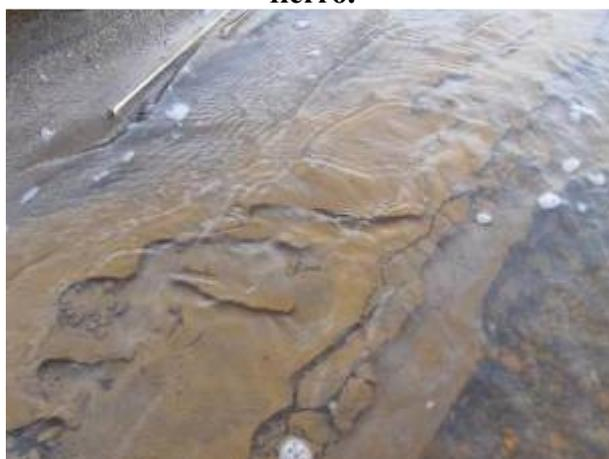
**Figura 58. Sedimentos de Lluta en Alcérreca con alto contenido de oxihidróxidos de hierro. Cerca de 28 mg Fe/g sedimento o un 6% del sedimento como  $\text{Fe}(\text{OH})_3$ . Este sedimento tiene del orden de 1,3 mg As/g sedimento, muy probablemente como especie sorbida al hierro.**
