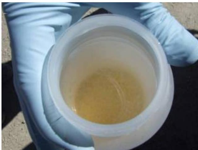
**Figura 21. Flóculos de hidróxidos de fierro formados gracias a la adición de base en Caracarani aguas abajo de la junta con el Azufre.**
